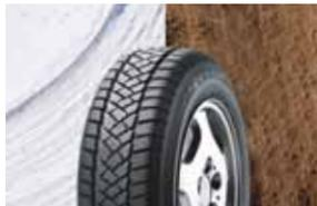
Dunlop SP LT 60 se ponaša z dezenom tekalne plasti, izpopolnjenim za vožnjo po zimskih cestah. Osrednji del z lamelami omogoča zanesljiv oprijem na mokri in zasneženi podlagi. Globoki prečni kanali in odprt ramenski del učinkovito razpršujejo vodo in tako preprečujejo akvaplaning.
