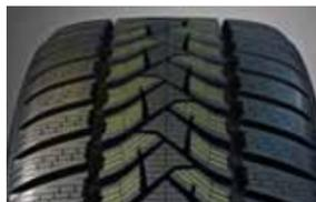
Lamele pod kotom v osrednjem delu tekalne plasti pnevmatike, ki zdaj potekajo vzporedno z robovi blokov in jih tako podaljšajo, povečujejo zmogljivost blokov, da se odprejo in oprimejo cestne površine ter s tem zagotovijo odličen bočni oprijem na spolzkih površinah.
