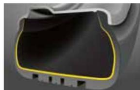
Zgradba zmanjšuje deformacijo karkase, to pa pomeni manjši kotalni upor. Gladko območje na zgornjem delu bočnice in ramenskem delu omogoča lažji pretok zraka vzdolž pnevmatike in tako zmanjšuje zračni upor.
